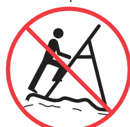
A4. Apoye la escalera sobre una base plana
